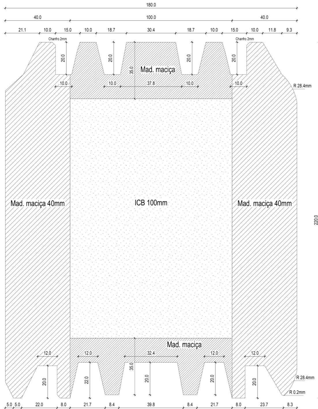
**Figura 1:** Características geométricas do painel “ISOLAM W180 – Face exterior plano / Face interior boleado”. Vista em planta. [dimensões em mm]
