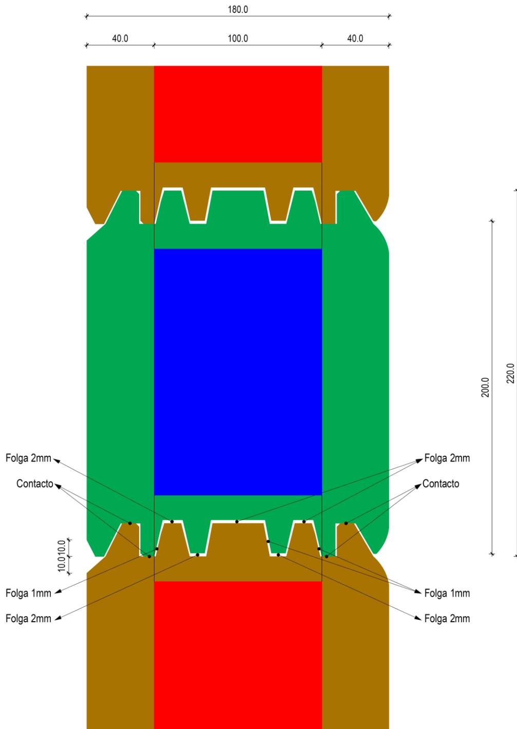
**Figura 2:** Características geométricas de parede com painel “ISOLAM W180 – Face exterior plano / Face interior boleado”. Vista em planta. [dimensões em mm]
