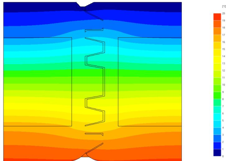
**Figura 3:** Distribuição bidimensional de temperaturas em paredes com painel “ISOLAM W180 – Face exterior plano / Face interior boleado”
