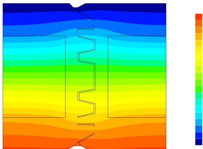
**Figura 3:** Distribuição bidimensional de temperaturas em paredes com painel "ISOLAM W180 – Face exterior plano / Face interior boleado"
