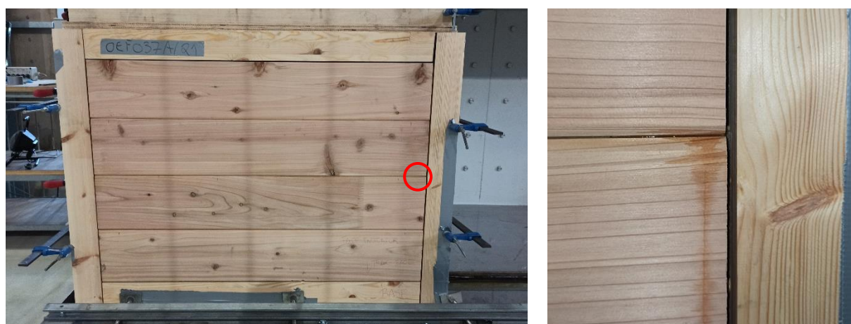
Figura 7 – Identificação dos pontos onde se verificou a perda de estanquidade do provete.
