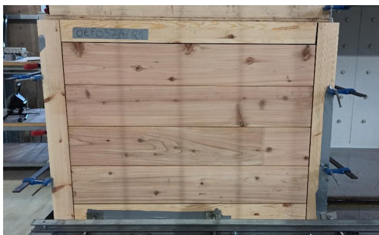
Figura 3 – Provete instalado na câmara de ensaios.
