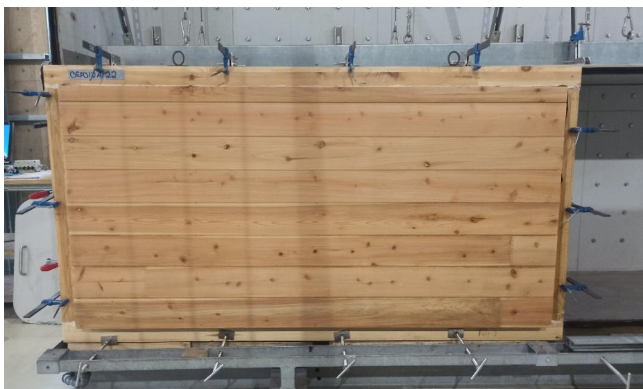
Figura 3: Provete instalado na câmara de ensaios.
