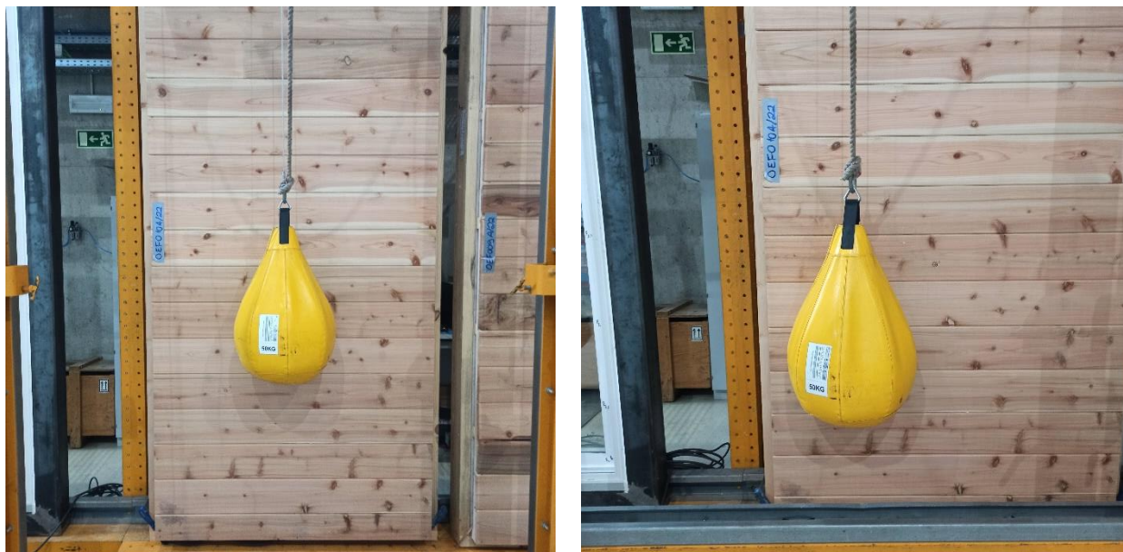
Figura 6: Registo fotográfico do provete após a realização dos ensaios: a) impactos com corpo duro (10 J); b) impactos com corpo mole (900 J).
